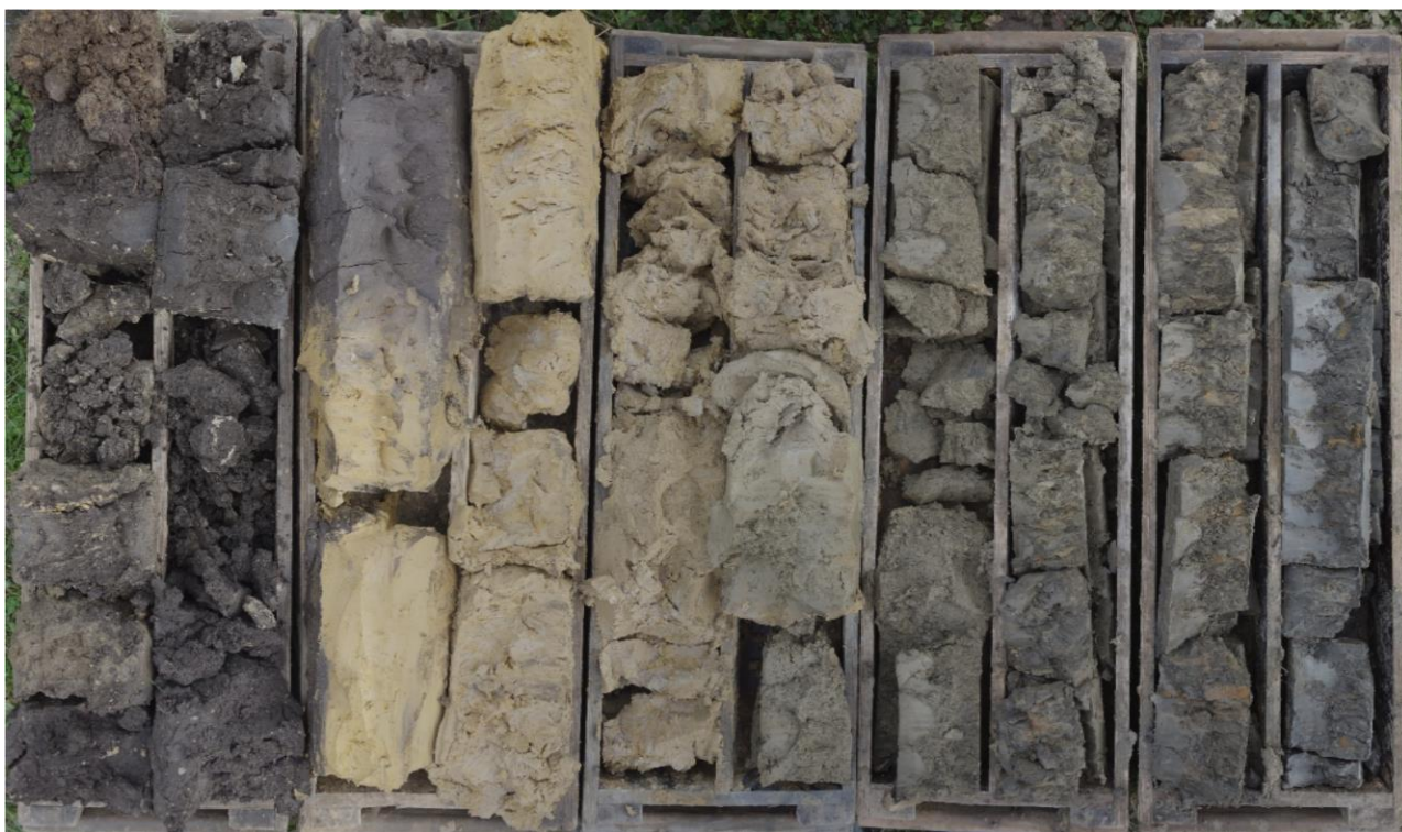
Foto č. 1: Vrtaná, jádrová sonda S1. Eluvium skalního podloží zastiženo v úrovni cca 2,4 m p.t., hornina třídy R5/R4 od cca 9,3 m p.t.. Podzemní voda tlaková, naražená v cca 7,0 m p.t., ustálená 1,5 m p.t..
