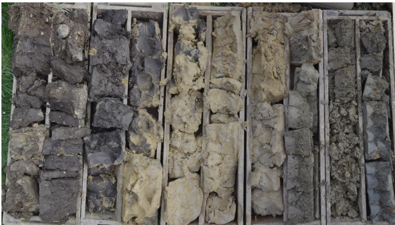
Foto č. 3: Vrtaná, jádrová sonda S3. Eluvium skalního podloží zastiženo v úrovni cca 3,7 m p.t., hornina třídy R5/R4 od cca 9,6 m p.t.. Podzemní voda tlaková, naražená v cca 8,4 m p.t., ustálená 1,5 m p.t..
