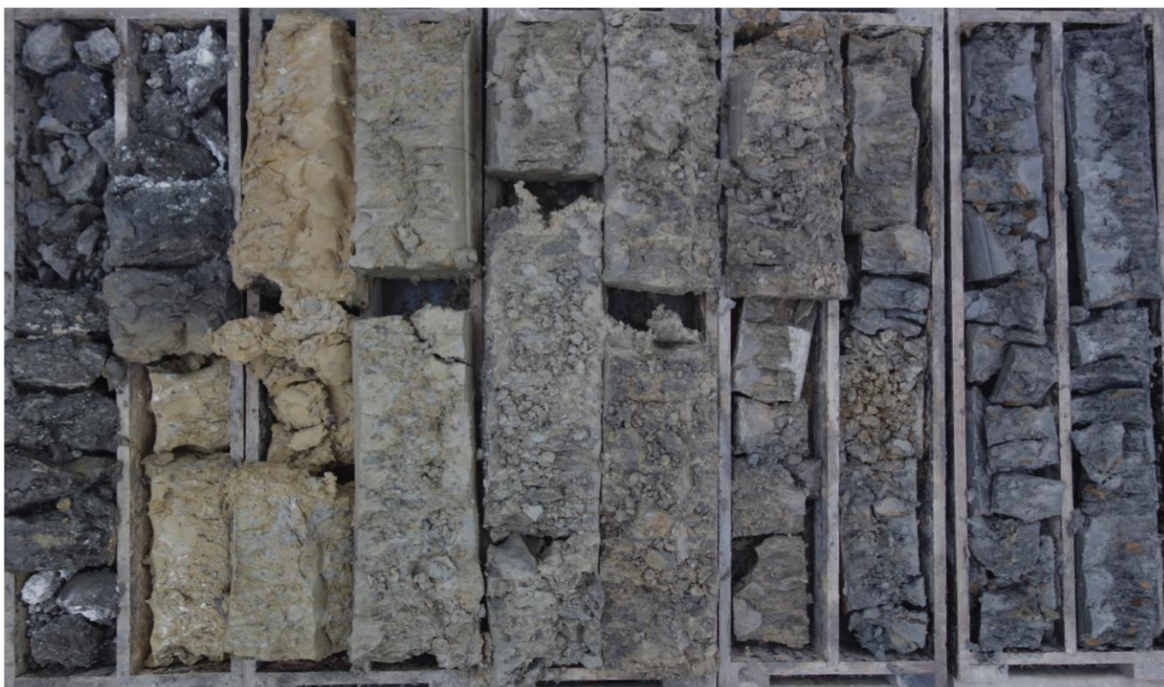
Foto č. 2: Vrtaná, jádrová sonda S2. Eluvium skalního podloží zastiženo v úrovni 1,5 m p.t., hornina třídy R5/R4 od cca 7,3 m p.t.. Podzemní voda tlaková, naražená v cca 4,5 m p.t., ustálená 1,25 m p.t..
